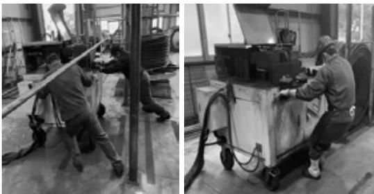
ロール交換時、作業台が小さく取り外したロールを違う場所へ運ぶムダが生じていたが(左)、作業台を大きくすることで、ロールをすぐ横に置き、重量物を運ぶ作業がなくなった(右)
